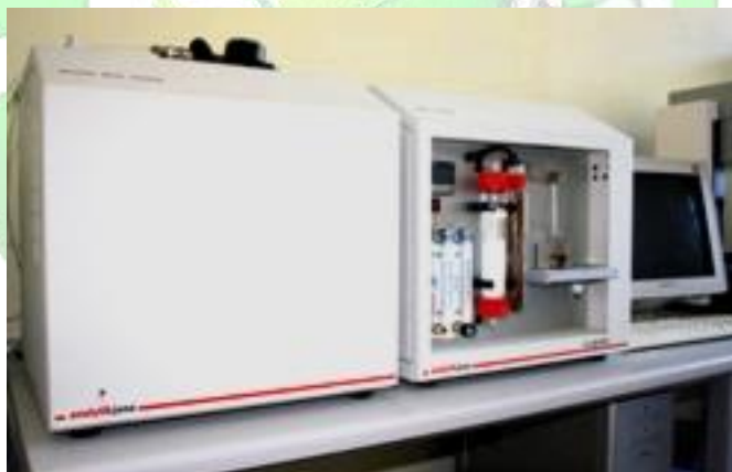
Rys. 1. Analizator węgla i azotu TOC Multi N/C 2000, HT 1300
